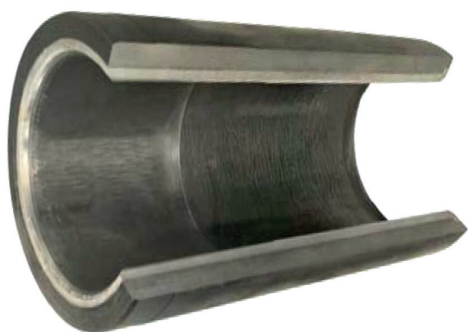
Рис. 6. Зовнішній вигляд наплавленої втулки діаметром 160 мм
