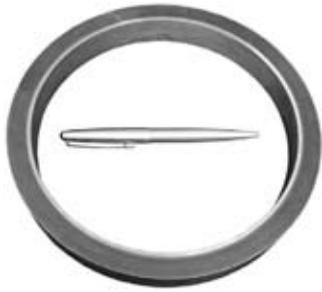
Рис. 12. Макрошлиф поперечного сечения втулки
